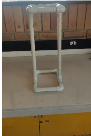
Imagen 20. Base para el electrolizador y recolector
