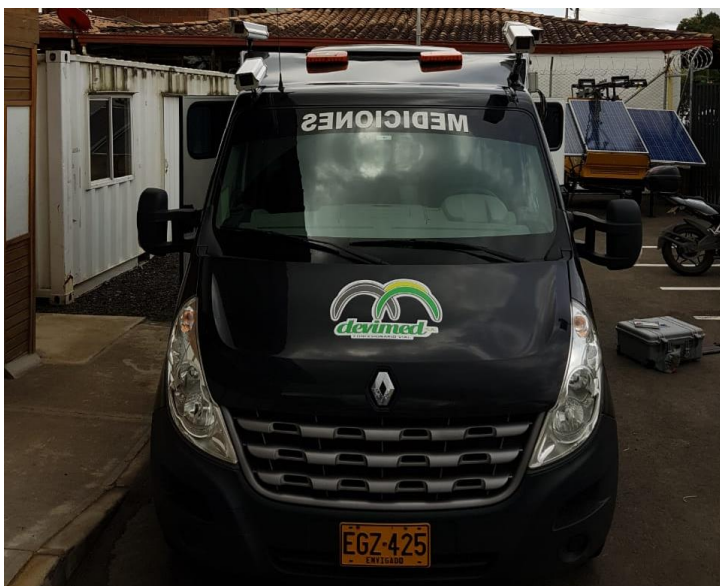
Fotografía 2. Cámaras de alta resolución instaladas en el vehículo de medición. Fuente: Propia
