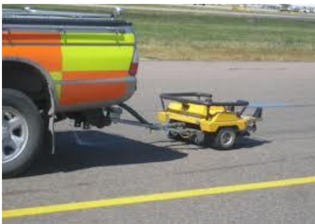
Figura 16. Implementación del Grip-Tester en el vehículo de medición. Fuente: Propia
