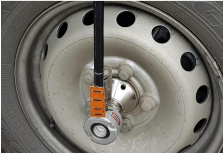
Fotografía 5. Odómetro instalado en el vehículo de medición. Fuente: propia
