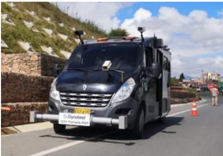
Fotografía 7. Perfilómetro instalado en el vehículo de medición. Fuente: Propia
