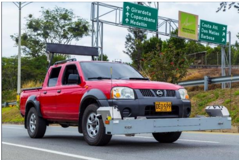
Fotografía 8. Perfilómetro de la interventoría para medición de ahuellamientos. Fuente: Propia
