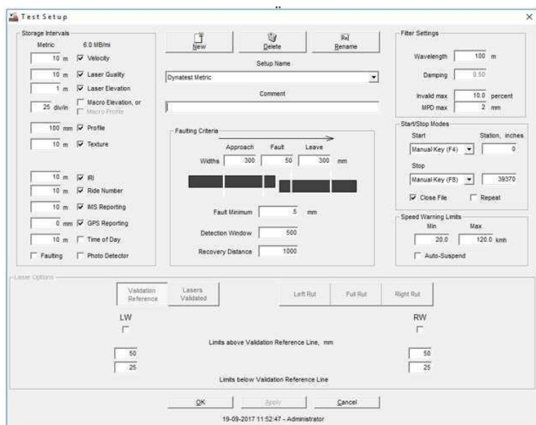
Figura 13. Calibración de parámetros para la medición del perfil longitudinal. Fuente: Propia
