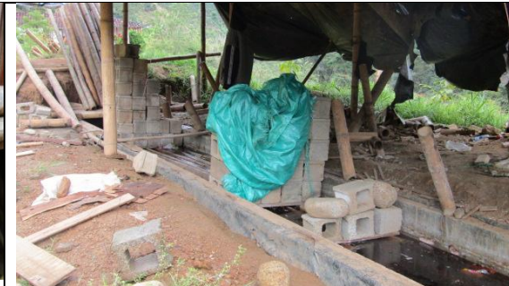
Baño de inmersión con solución a base de ácido bórico para inmunización.
