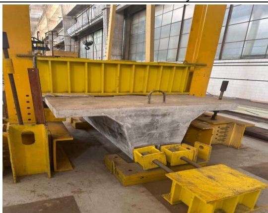
Viga sección Cajón Hueca pretensado, concreto reforzado con fibras vidrio UFRJ
