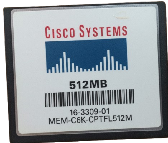
Figura 1.3: Ejemplo de tarjeta CompactFlash utilizada para almacenamiento en el router.
