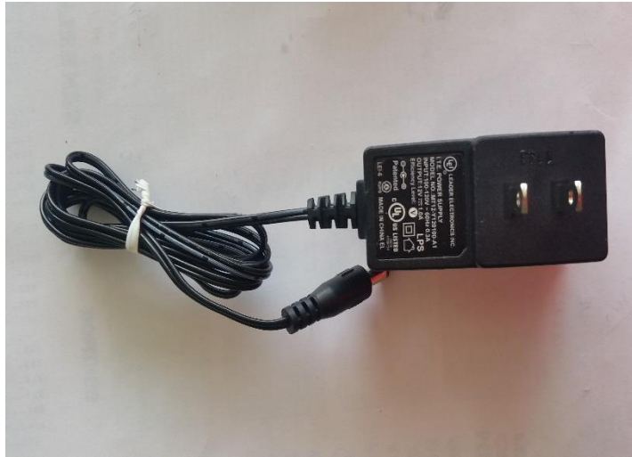
Figura 35. Cargador de 12VDC empleado para la alimentación de la electroválvula Fuente: Autor
