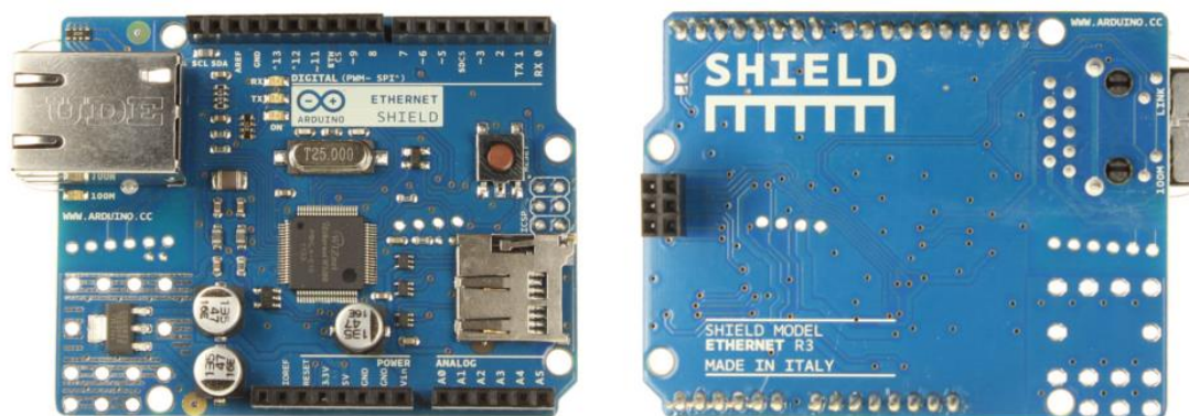
Figura 52. Módulo de Ethernet incorporado a la tarjeta de Arduino Mega Fuente: Autor
