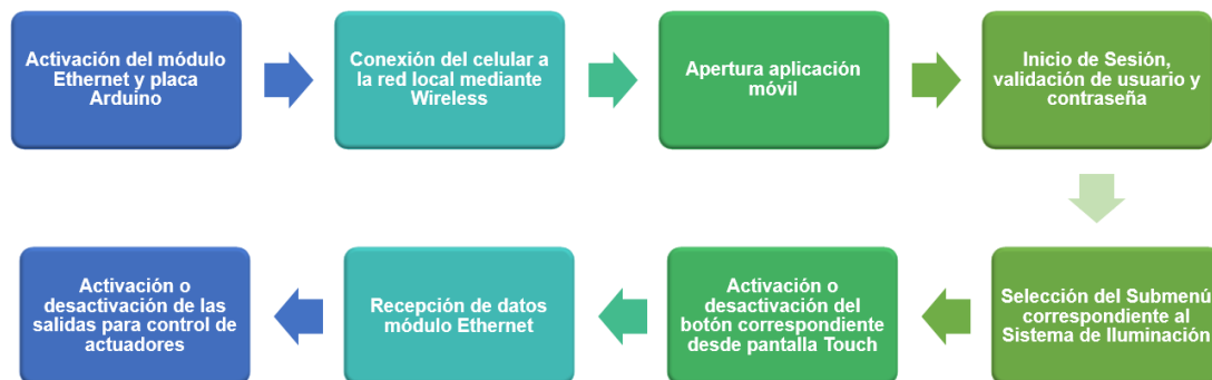
Figura 27. Diagrama de bloques, síntesis funcionamiento sistema de iluminación. Fuente: Autor
