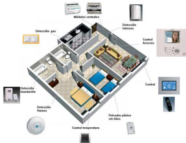
Figura 9. Ilustración de los dispositivos que conforman el sistema domótico. Fuente: http://domoticakeesse.blogspot.com.co/2015/05/domotica.html
