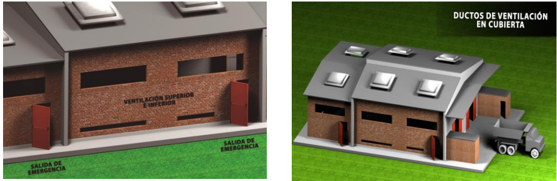
Fotografía 14: Sistema de ventilación centro de acopio
