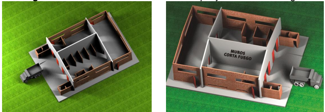
Fotografía 13: Distribución del centro de acopio y muros contrafuego
