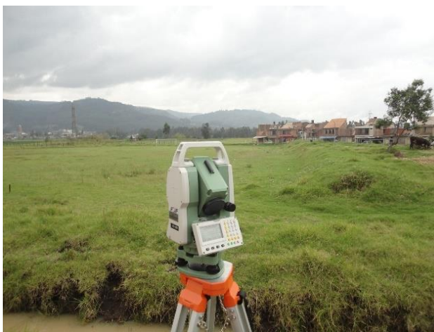
Fotografía 8. Levantamiento topográfico alcantarillado pluvial Vereda Nazareth.
