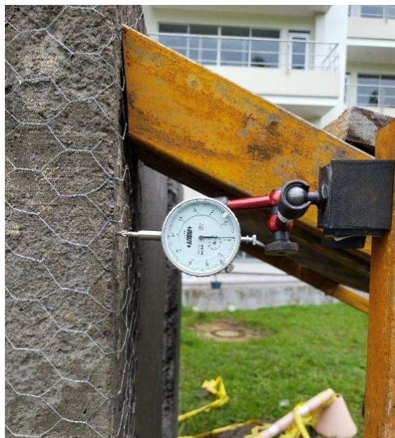
Figura 23. Deformímetro equipado para medir el desplazamiento lateral Fuente: Autor.
