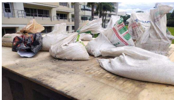
Figura 25. Sacos de arena simulando cargas verticales. Fuente: Autor.
