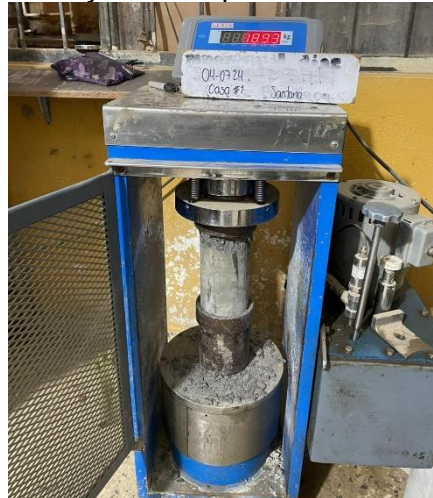
Ilustración 10. Ensayo de compresión INV. E-410 ASTM C39
