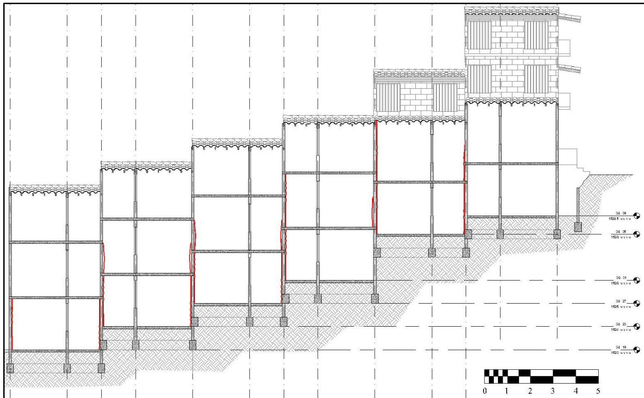
34 Fisuración muros medianeros. corte A-A'
