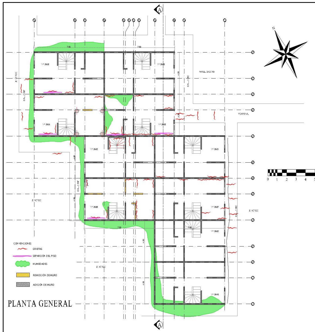
38 Localización fisuras y grietas Mz 10
