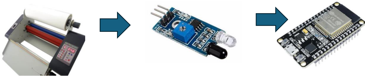
Figura 3. Diagrama del sistema de conteo del número de láminas de la Plastificadora
