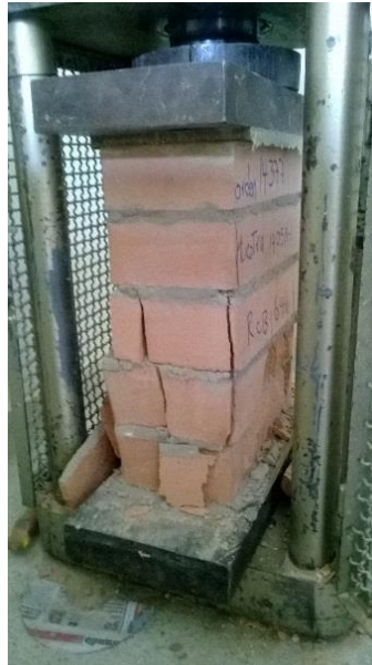
Figura 19. Resistencia a la compresion de prisma de mampostería
