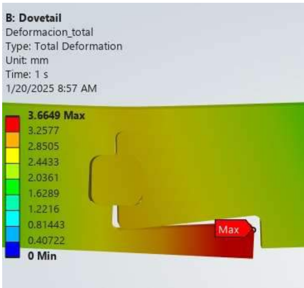
Ilustración 23. Resultados desplazamiento simulación Dovetail
