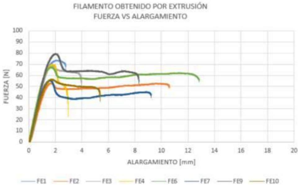
Ilustración 15. Fuerza vs alargamiento de filamento obtenido por extrusión [14]
