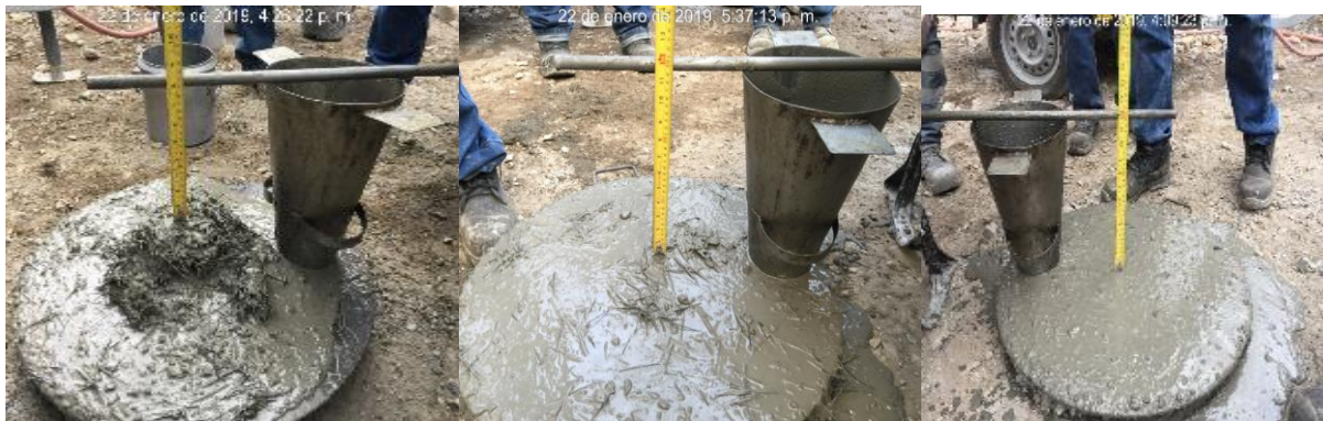
Ilustración 43 Pruebas de Asentamientos (Autor: Fuente Propia)
