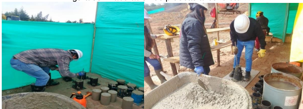
Figura 33. Elaboración de pruebas al concreto.
