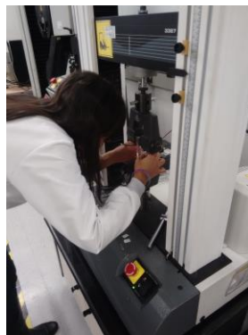
Figura 11. Ubicación del modelo acrílico en la máquina universal de ensayos Instron ®
