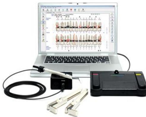
Figura 7. Componentes básicos de la Sonda Florida. Fuente: www.floridaprobe.com
