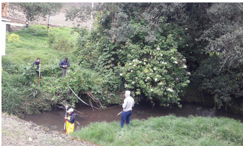
Ilustración 16 Toma de datos de topo batimetría y velocidades transecto 2, elaboración propia.
