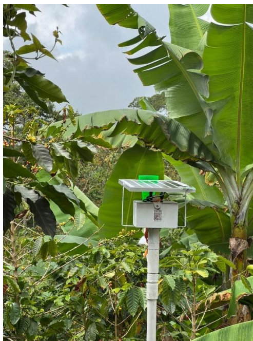
Ilustración 61 - Colocación final 1 - Módulo de sensores Fuente: autoría propia
