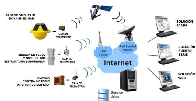
Ilustración 2 – Componentes de un sistema de telemetría [38]
