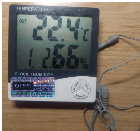
Ilustración 18 - Termohigrómetro. Fuente: Autoría propia
