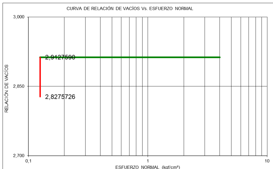
Figura 74. Condición de Expansión Probeta 1 (5% de Cemento)
