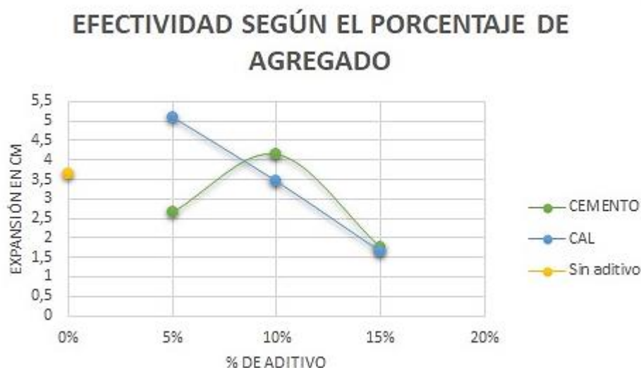
Figura 79. Variación de la Expansión con Agregados
