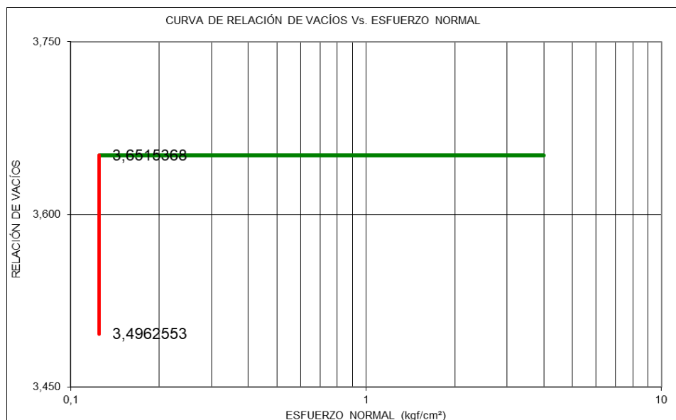
Figura 69. Condición de Expansión Probeta 2 (10% de Cal)
