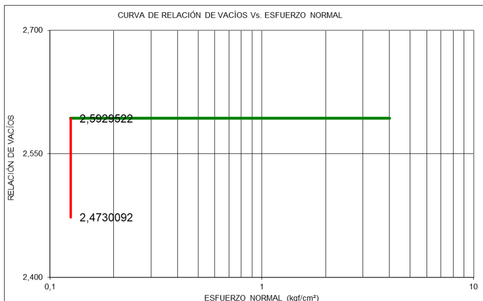
Figura 76. Condición de Expansión Probeta 2 (10% de Cemento)
