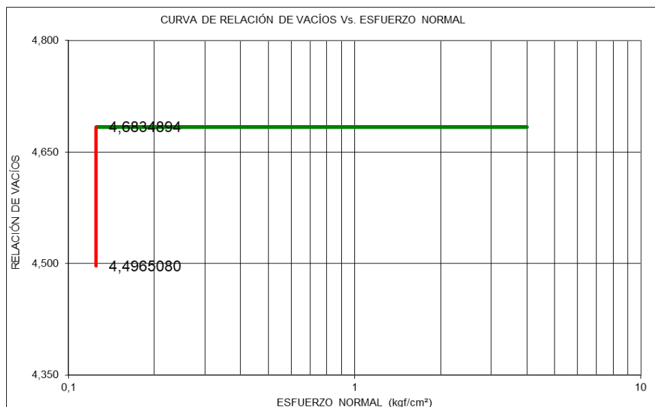
Figura 67. Condición de Expansión Probeta 1 (5% de Cal)
