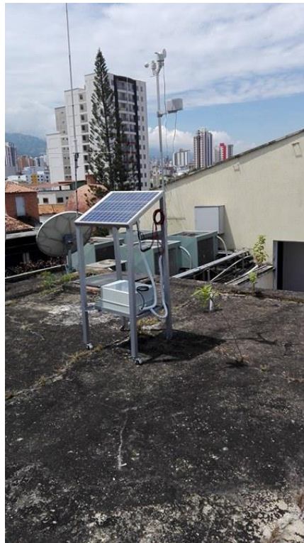
Figura 26 Prototipo final de la estación meteorológica
