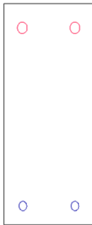
Ilustración 24 Acero de refuerzo para las vigas de 30 X 50 cm.
