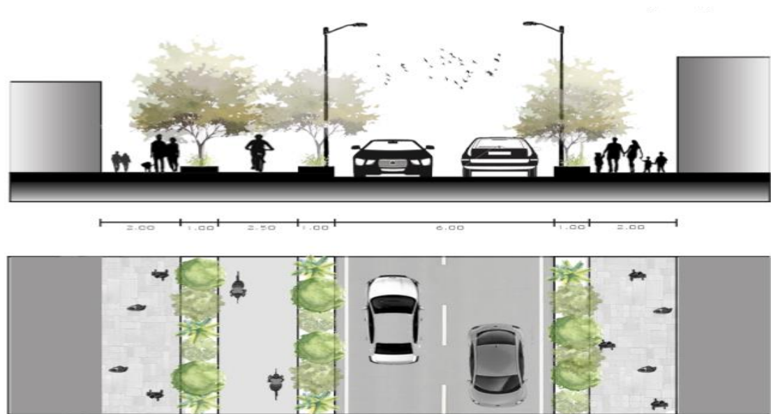
28.Figura N°28 Perfil propuesta vía principal
