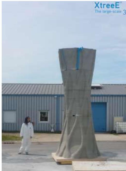
Figura 56. Columna impresa en 3D con balsas de soporte Adaptado: Archdaily, 2020
