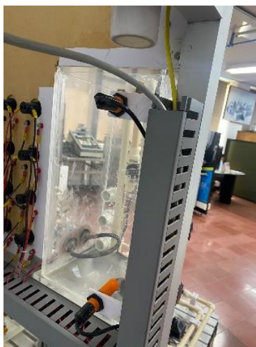
Figura 42. Ubicación de los sensores capacitivos en el tanque de procesos T1.
