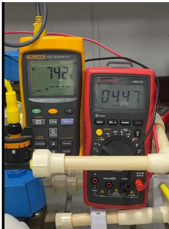
Figura 28. Mediciones de temperatura en termopar y voltaje en sensor MTB3560.
