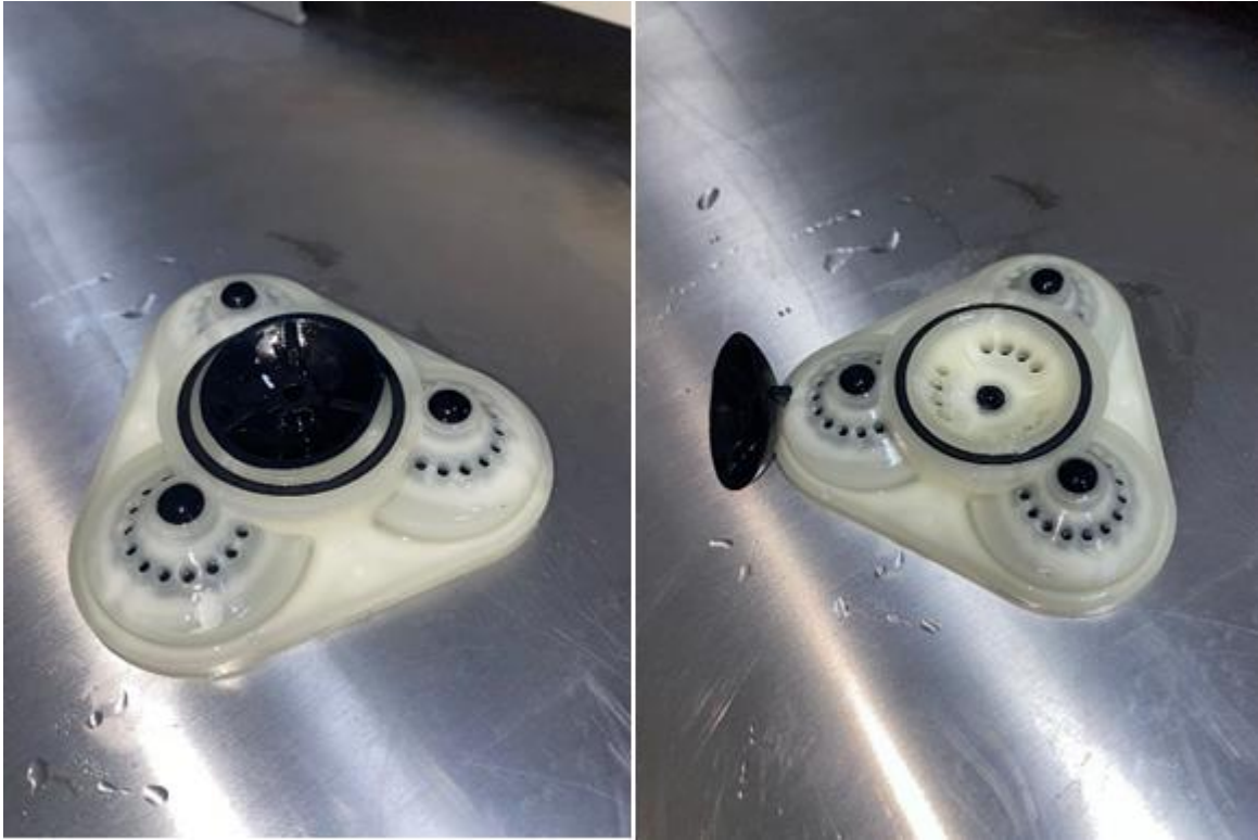
Figura 24. Daño de la membrana de la bomba EB2 en planta 2.
