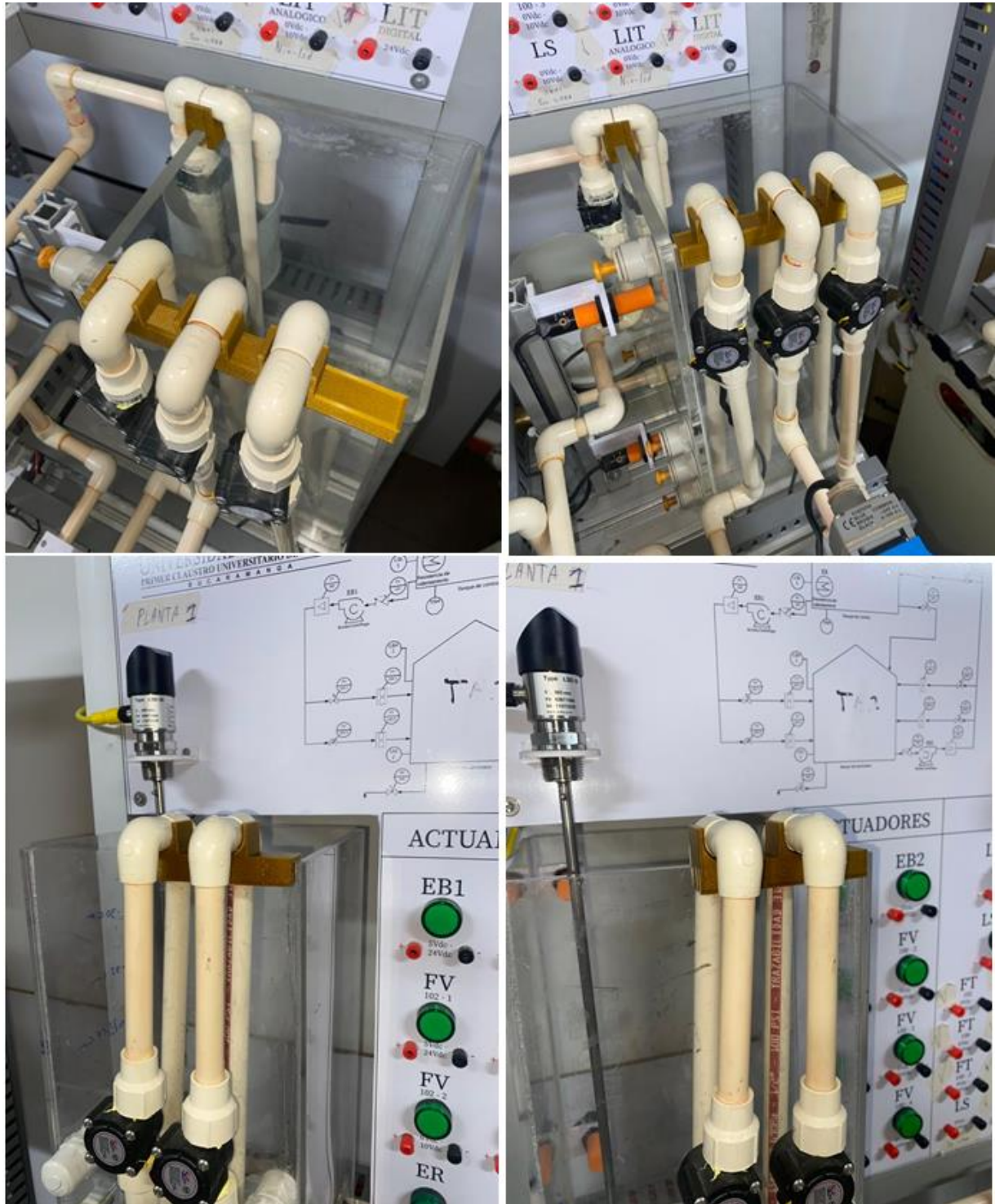
Figura 27. Soportes sustitutos impresos en 3D.
