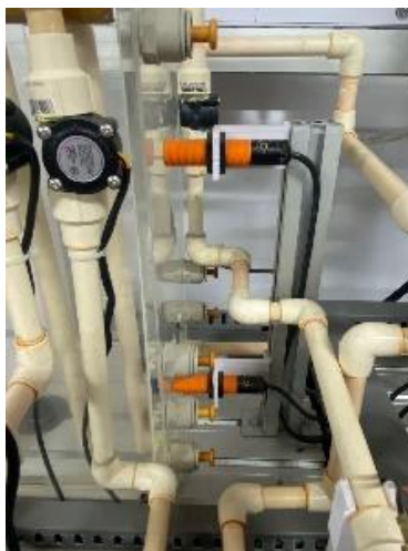
Figura 42. Ubicación de los sensores capacitivos en el tanque de procesos T1.
