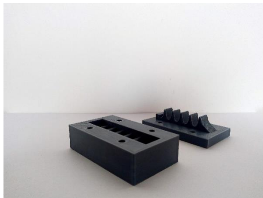
Figura 9. Vista isométrica del núcleo y la cavidad de la zona de lóbulos.
