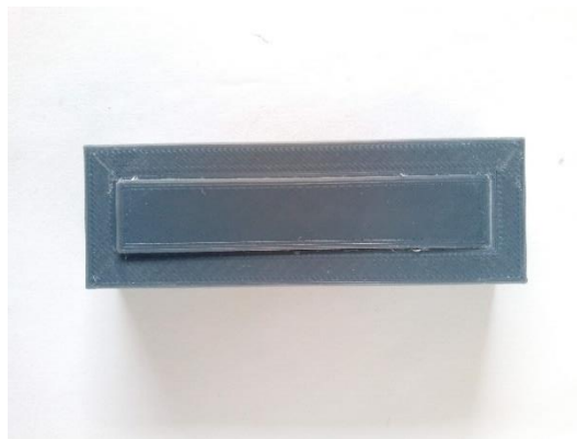
Figura 15. Núcleo y cavidad de la zona de agarre con capa de látex aplicada ensamblados.
