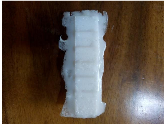
Figura 21. Vista frontal de la pinza retirada de la zona de la cavidad con el borde de silicona.
