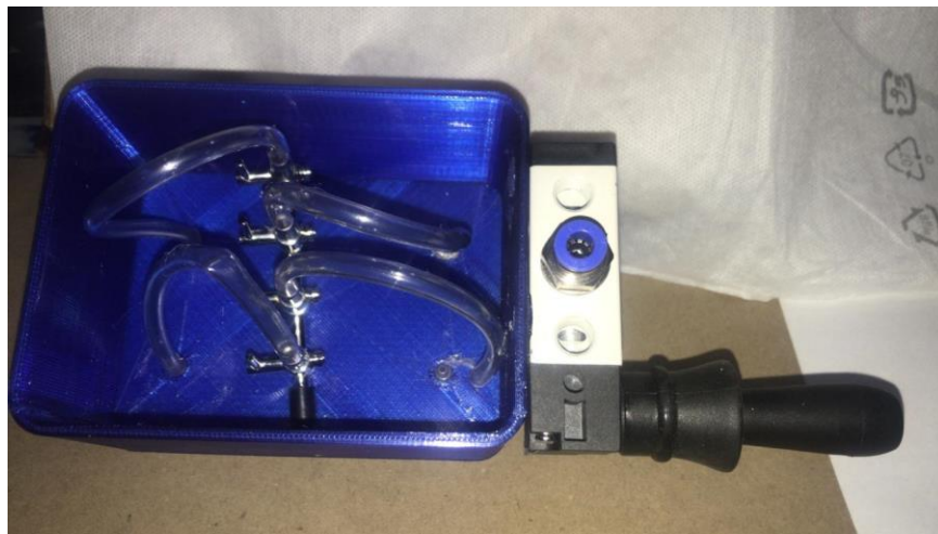
Figura 46. Circuito neumático integrado a la caja de sujeción.
