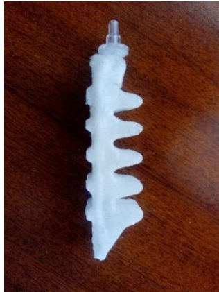
Figura 25. Pinza con unión para manguera acoplada.
