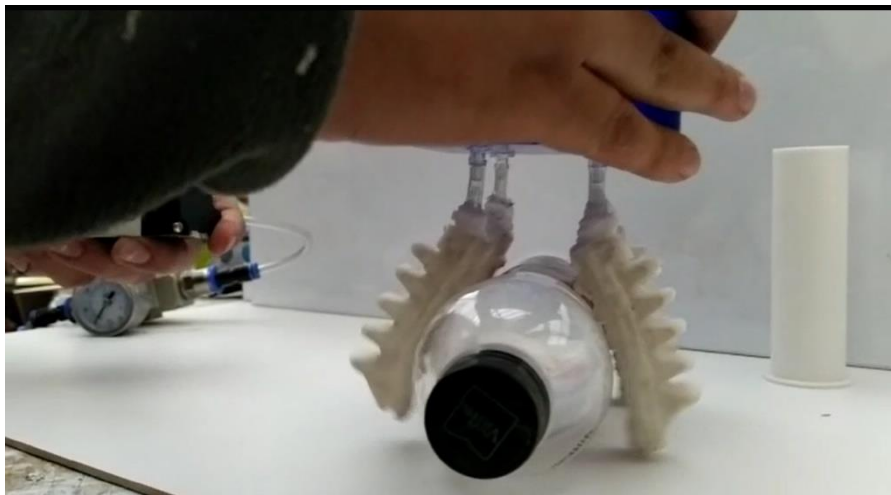
Figura 47. Gripper flexible realizando el agarre del objeto.
