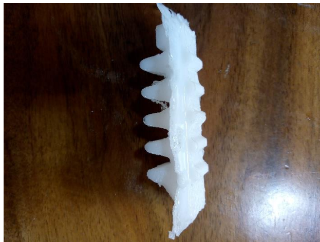
Figura 22. Vista lateral de la pinza retirada de la zona de la cavidad con el borde de silicona.
