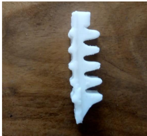
Figura 24. Vista lateral de la pinza con el borde de silicona recortado.
