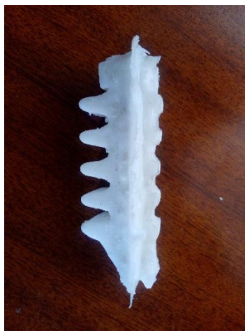
Figura 27. Vista lateral de la pinza gruesa retirada de la zona de la cavidad con el borde de silicona.
