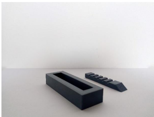
Figura 11. Vista isométrica del núcleo y la cavidad de la zona de agarre.
