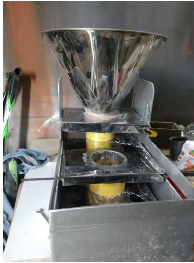
Figura 22. Tolva y estructura principal, fuente: fotografía propia
