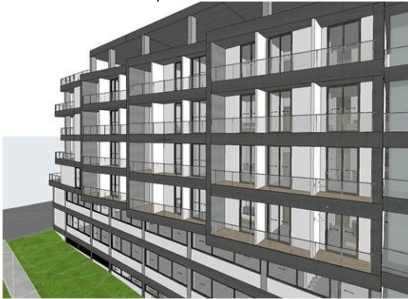
Figura 67. Control de radiación solar a partir de la modulación
