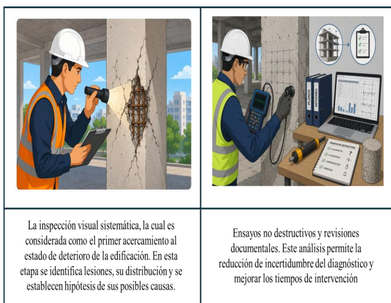
Figura 3. Inspección visual y ensayos no destructivos en patología de la construcción.
