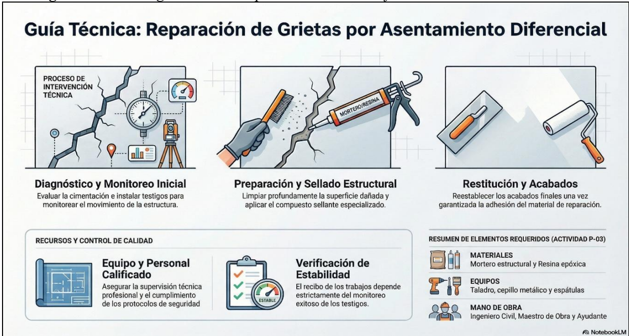
Figura 36. Patología 5 - Grietas por asentamiento diferenciales
