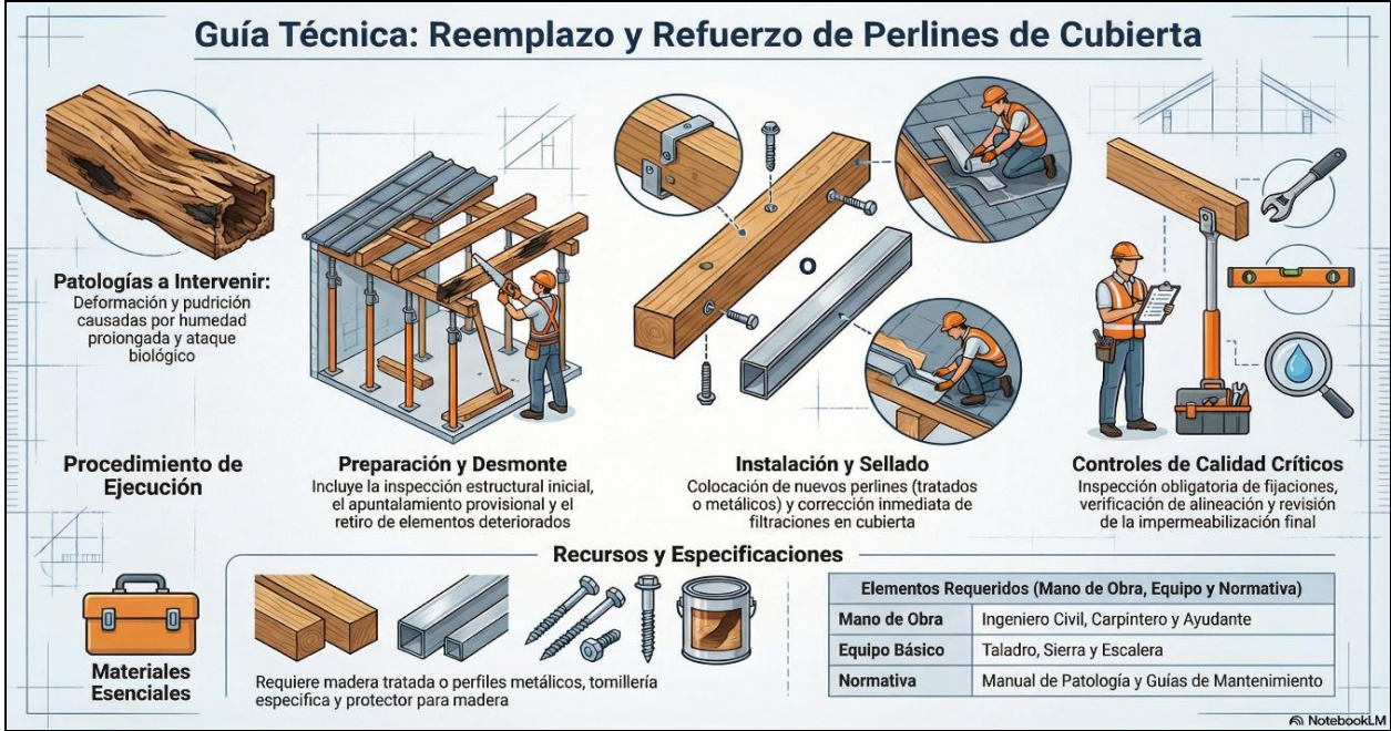
Figura 34. Patología 3 - Reemplazo y Refuerzo de Perlines de Cubierta
