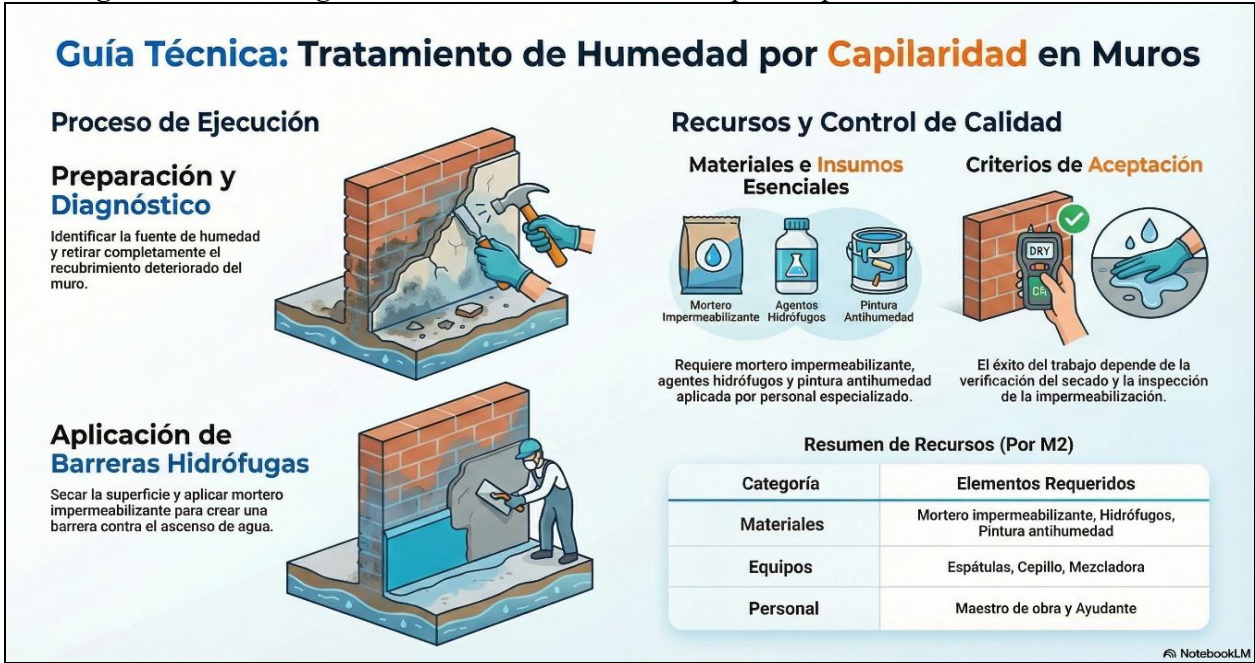
Figura 35. Patología 4. Tratamiento de Humedad por Capilaridad en Muros
