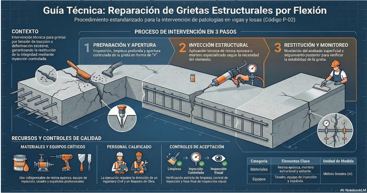
Figura 33 . Patología 2 - Reparación de grietas estructurales por deflexión
