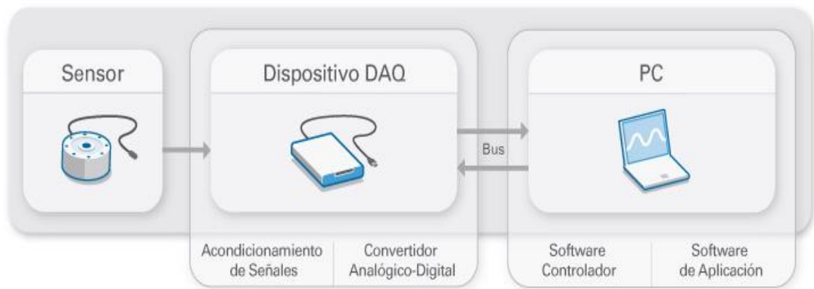
Figura 16. Funcionamiento de la tarjeta de adquisición de datos (DAQ).
