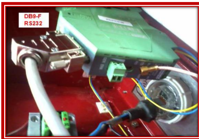
Fig 70. Conexión RS232 al contact Phoenix
