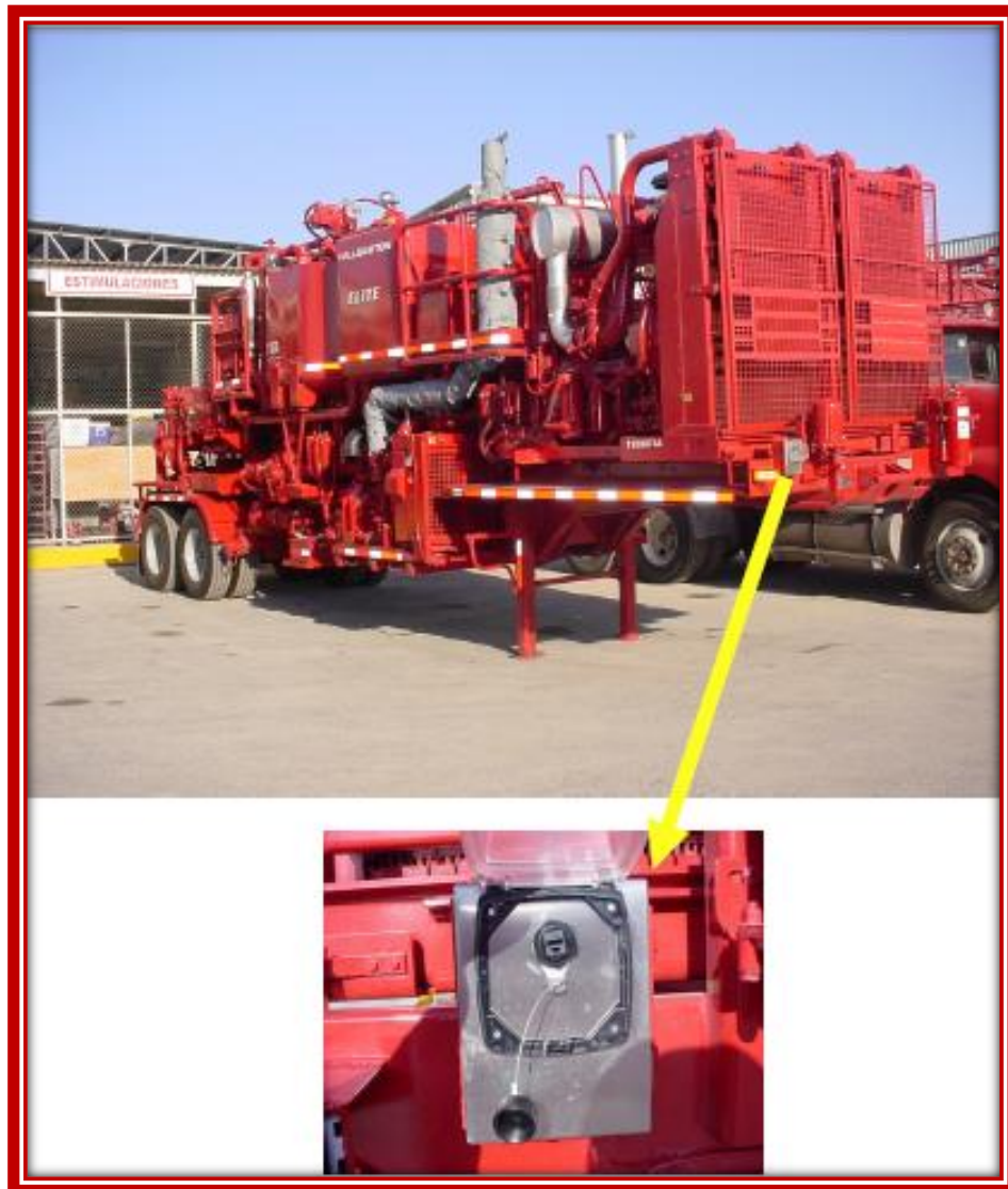
Fig. 8. Comunicación implementando cableado de la unidad de cementación al punto de control
