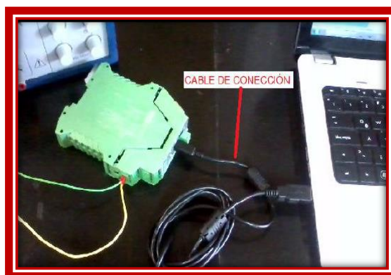
Fig 36. Pruebas en lab electrónica. Conexión del cable mini USB del módulo al puerto USB del PC.
