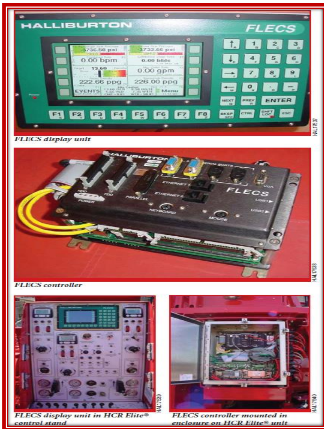
Fig 14. Sistema de control FLECS [6].
