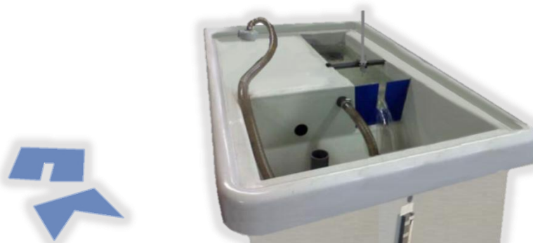
Fig. 3 Equipo para visualizar el flujo a través de un vertedero y ranuras rectangular y triangular
