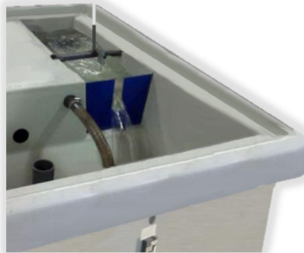
Adaptado de: Pérez R., H. (2011) "Guías para prácticas de laboratorio mecánica de fluidos" Fig. 5 Vertedero rectangular
