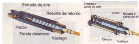
Figura 32. Esquema cilindro de simple efecto
