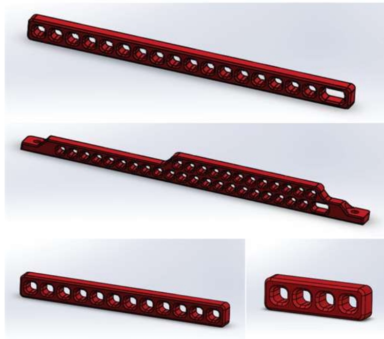
Figura 64. Diseño CAD de Organizadores para Cableado de Entradas y Salidas del PLC
