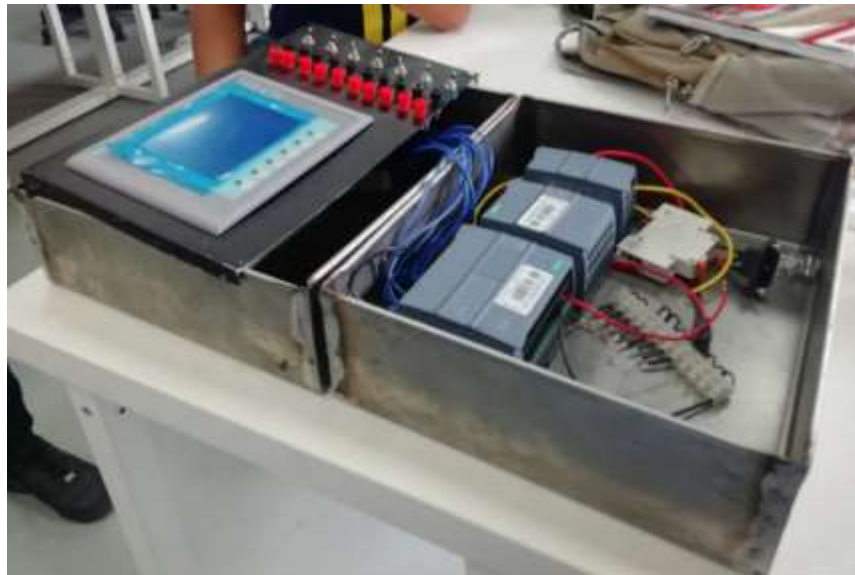
Figura 56. Distribución PLC en el maletín
