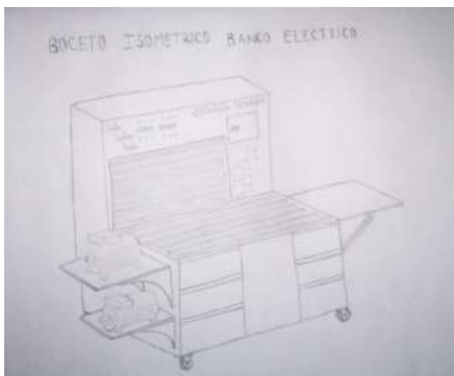
Figura 36. Boceto de la modificación del banco eléctrico
