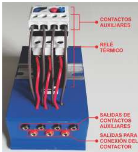
Figura 46. Montaje del Relé Térmico.
