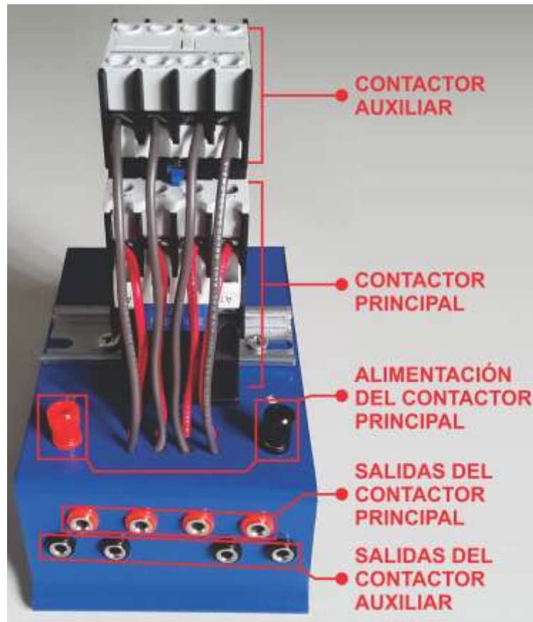
Figura 45. Montaje de Contactor con Contactos Auxiliares
