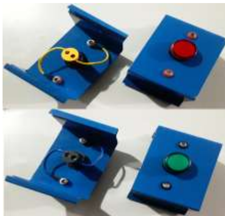
Figura 49. Montaje de Lámparas de Señalización
