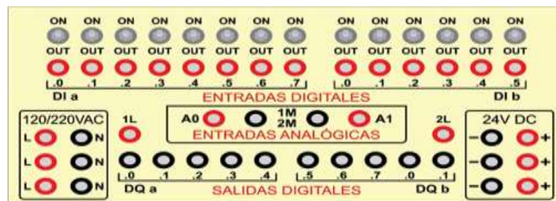
Figura 60. Tablero de Entradas y Salidas para el PLC al interior del Maletín Portátil
