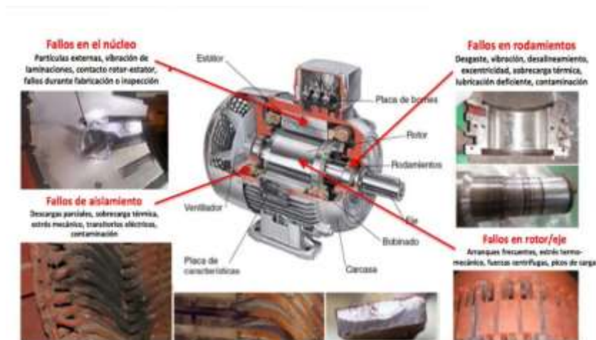
Figura 1. Motor eléctrico y sus partes
