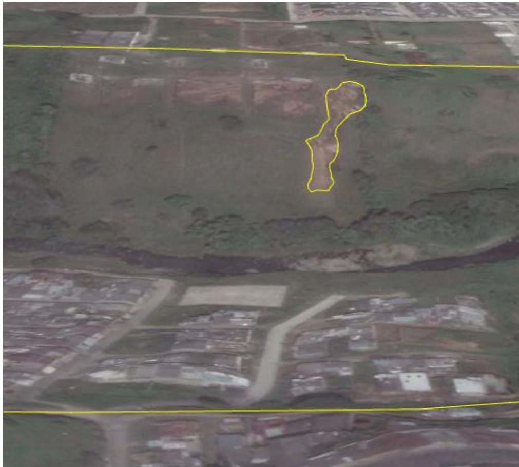
Figura 2. Delimitación de posible deslizamiento superficial en la vertiente de la Comuna I.
