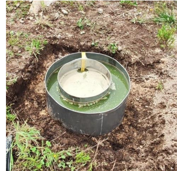
Imagen 9. Prueba de infiltración
