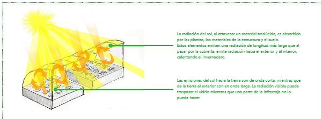
Figura 4. Funcionamiento del efecto invernadero y transferencia de calor en sistemas de cultivo protegidos.
