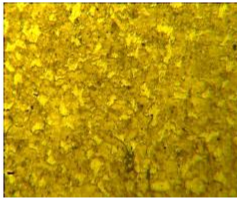
Figura 11 Probeta de acero 8620 a 100X- Normalizada. Fuente: 1 Aponte, E. S. S., Roballo, J. A. P., Torres, S. R., & Mancilla, Y. M. G. Análisis comparativo de las microestructuras de aceros tratados térmicamente
