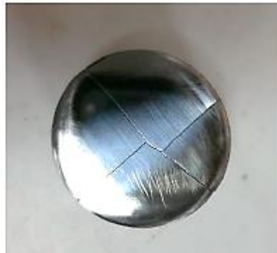
Figura 15 Probeta de acero 8620 fracturada por el temple en agua Fuente: 1 Aponte, E. S. S., Roballo, J. A. P., Torres, S. R., & Mancilla, Y. M. G. Análisis comparativo de las microestructuras de aceros tratados térmicamente
