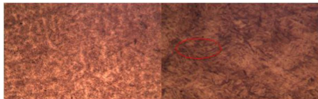
Figura 9 . Probeta de acero 4140 – Templado en aceite. (a) 100X, (b) 400X.
