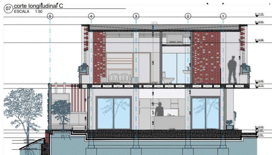
Figura 85. Corte longitudinal vivienda tipo 1
