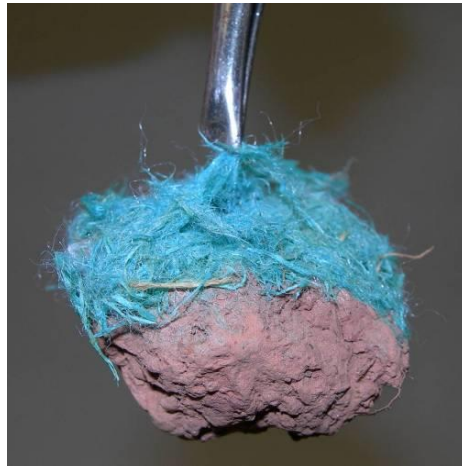
Imagen 5. Adherencias de hidromulch
