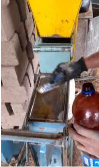
Anexo 5. Aplicación de ACPM a la maquina CIMVA RAM.
