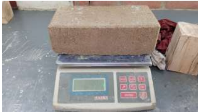
Figura 16. Toma de peso de muestra bloque en balanza.
