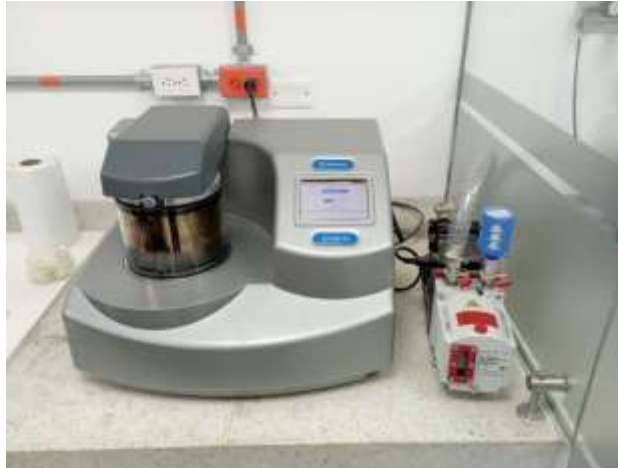
Figura 4. Grabador iónico de plasma de argón
