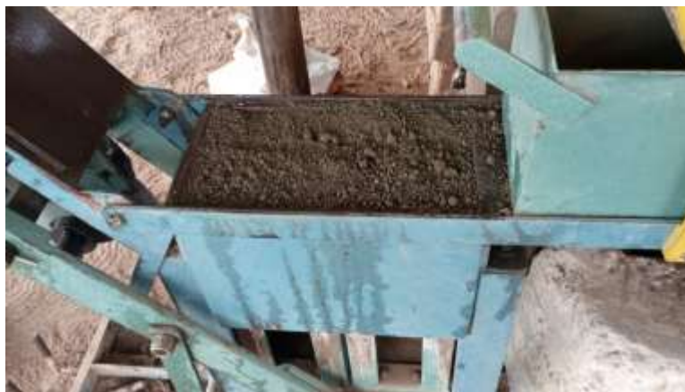
Figura 10. Mezcla en la cimva RAM.
