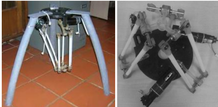
Figura 1. Prototipo funcional de arquitectura paralela tipo delta de 3 cadenas cinemáticas.
