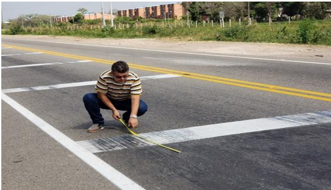
Figura 23. Levantamiento de áreas lesionadas con cinta métrica.
