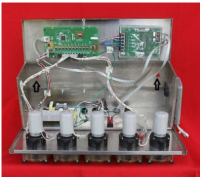
Figura 25 Gabinete bombas peristálticas y conexión a interfaz
