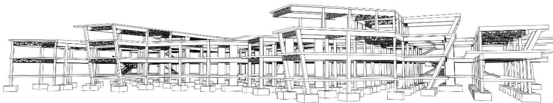
Ilustración 30. Isométrico estructural II.
