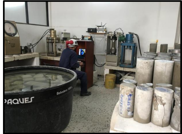
Imagen 8. Máquinas para falla de especímenes Imagen 9. Laboratorista realizando falla de un cilindro Fuente: Autora Fuente: Autora
