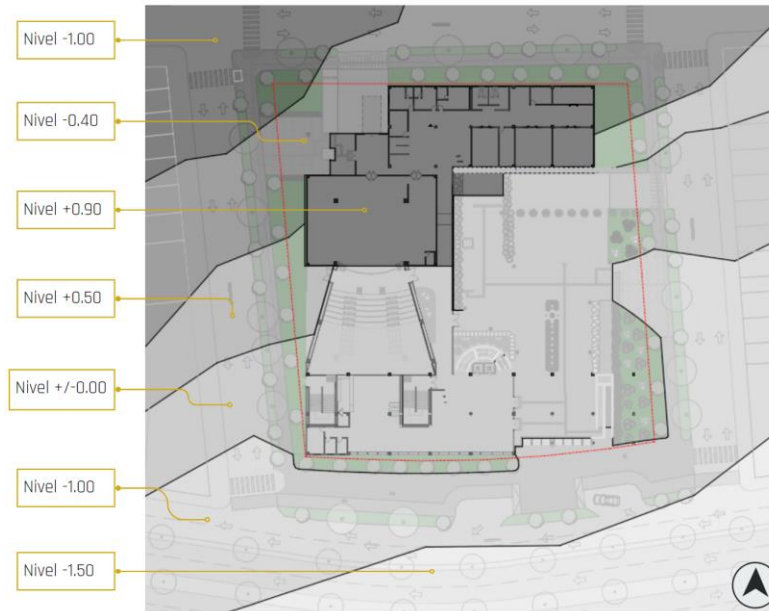
Figura 58. Adaptación de niveles
