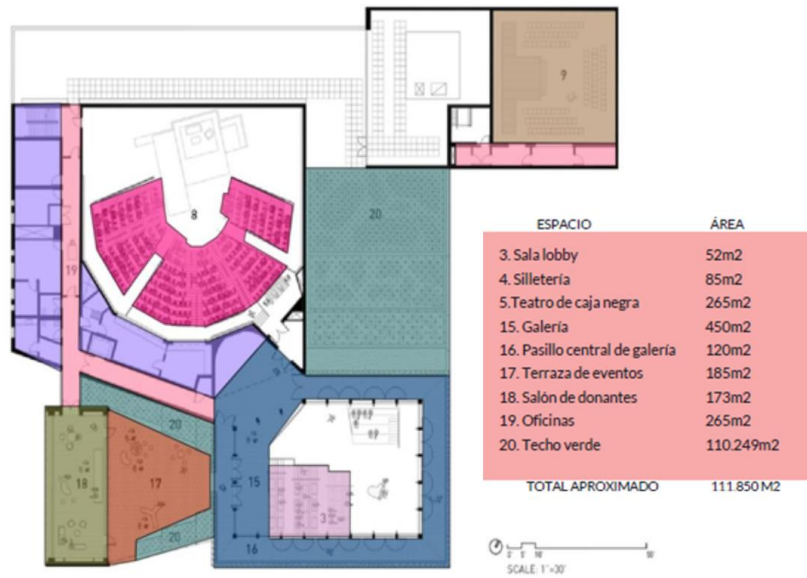
Figura 18. Planta segundo piso del teatro. Tipología internacional
