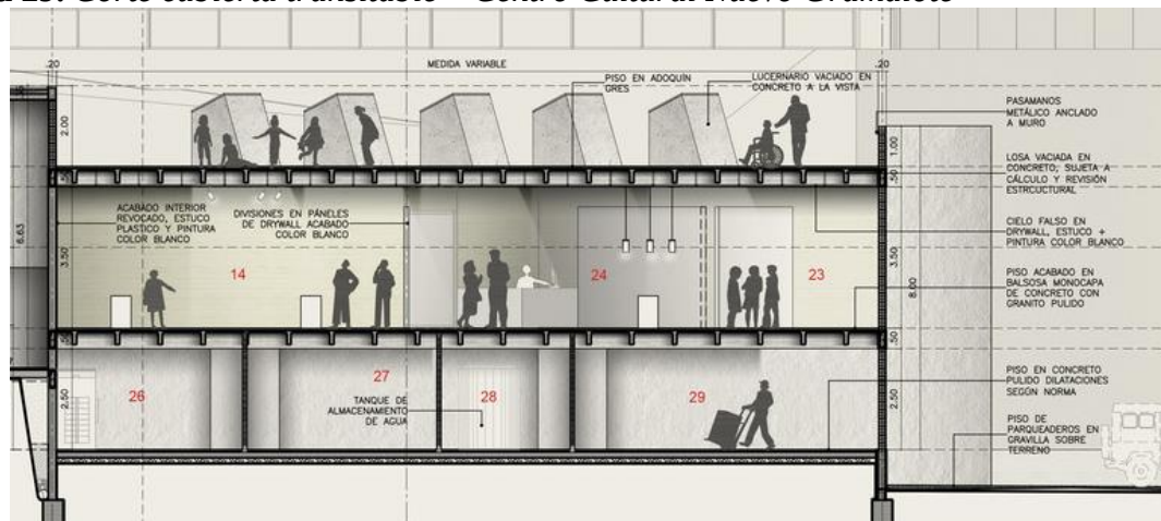
Figura 29. Corte cubierta transitable – Centro Cultural Nuevo Gramalote
