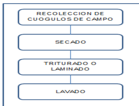
Figura 7. Diagrama a bloques del caucho de menor calidad.
