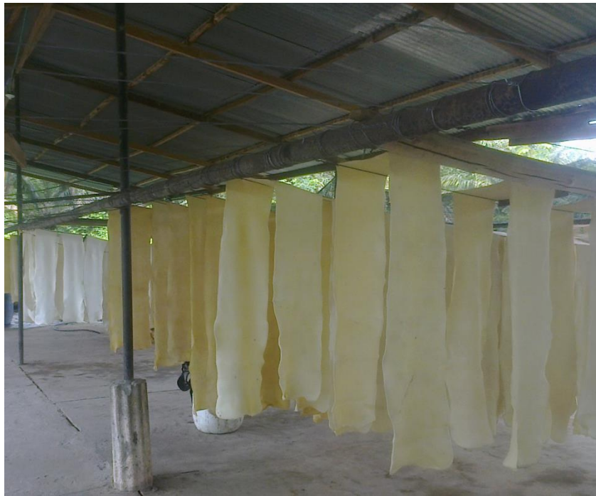
Figura 4. Secado de láminas de látex
