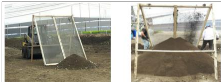
Ilustración 5. Tamizaje del compost maduro [21]
