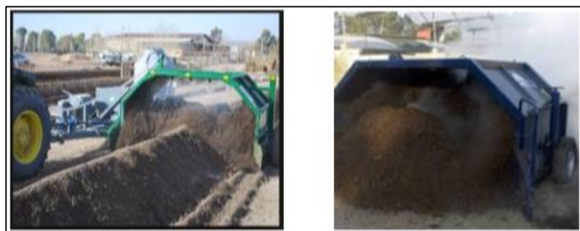
Ilustración 4. Volteo mecanizado de las pilas [21]
